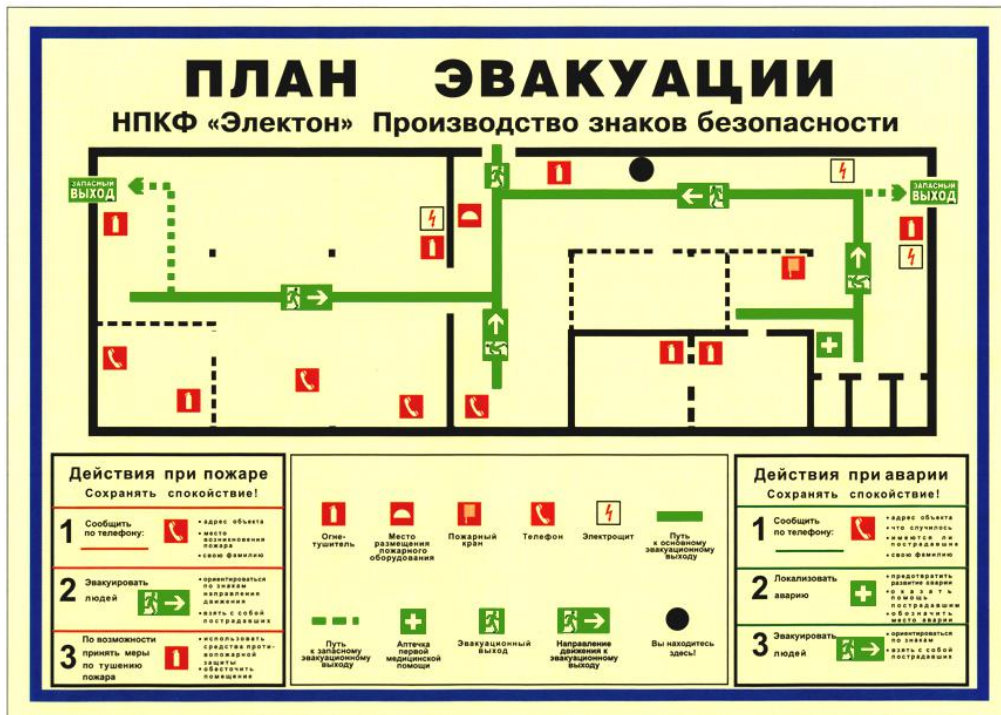
Рисунок В.2 - Секционный план эвакуации (фотолюминесцентный)
